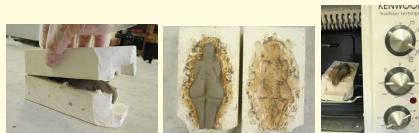
**Figure 6 :** Quand on a créé la forme désirée, on place l'objet dans un four à 60°C pendant 2h. Il faut augmenter le temps de séchage en fonction de l'épaisseur de l'objet à sécher.
